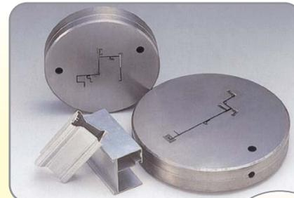
アルミサッシなどの材料を作るための押出ダイス
