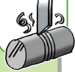
鋼塊を1000℃以上に熱くし、2本の円柱（ロールといいます）の間を何回も通して、鋼塊を縦の方向に伸ばします。こうしてできた角棒を「ビレット」といいます。この工程でできる角棒は、1辺が12センチぐらいの正方形の断面で、長さが8メートルぐらいです。
