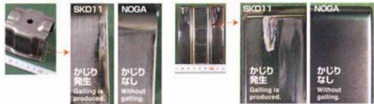
試験条件: ●ピン材: ハイテン鋼板100kgf ●試験荷重: 50kgf ●試験回転数: 64rpm
